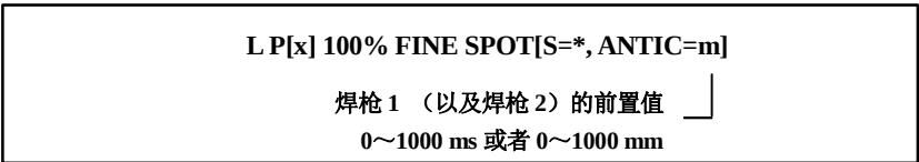
图 6.2 (b) 2 段行程无效时的 SPOT 指令的前置值
