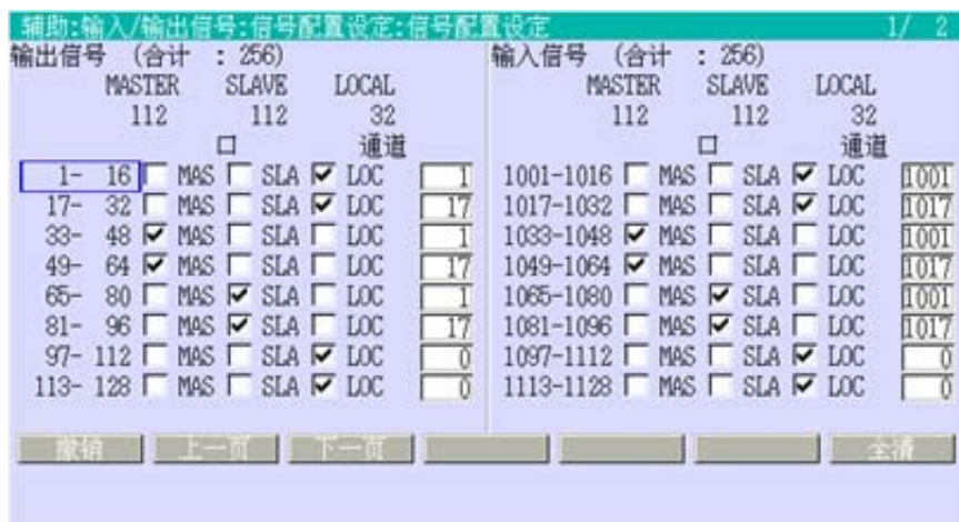
图 5.1 辅助 0608-1 信号配置设定例
